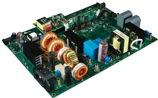
图 8 光伏微逆上使用的电感线圈与变压器
