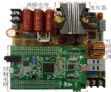
图7 实验用微逆调试平台
