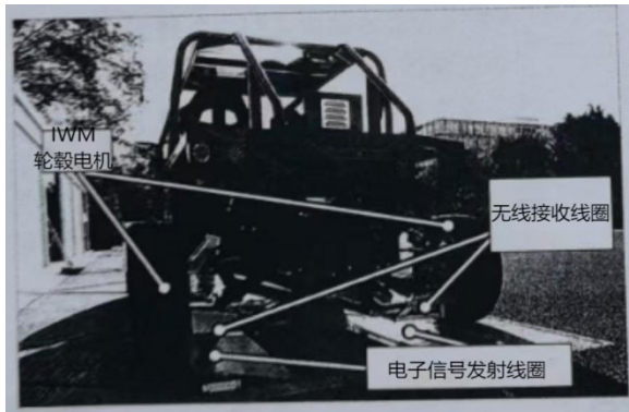
图1: 无线轮毂电动机的实验车辆
