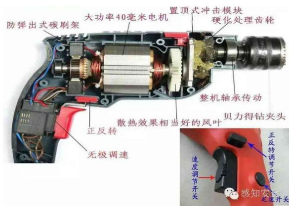
图3 电动工具基本构造与主要部件(2)
