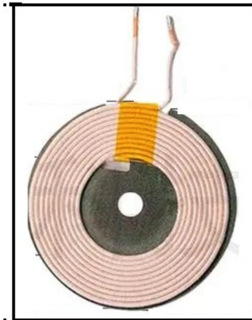
图1为无线充电线圈外形示意
