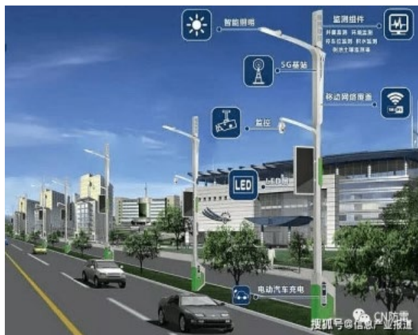
图4 智慧灯杆上面挂载的5G微基站
