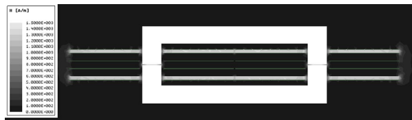
图 9 PSSP 结构基波分量磁场强度 H 分布
