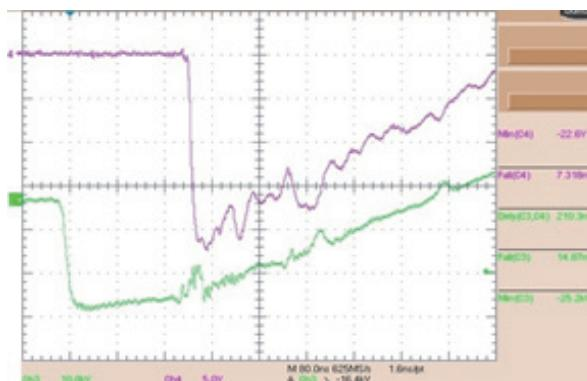
图 6 触发脉冲及高压脉冲输出波形
