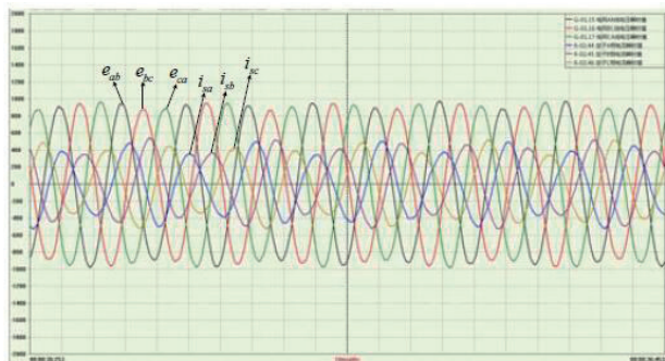
(b) 双馈机型中曾出现的低频振荡现象 图 1 风场曾出现的低频振荡现象
