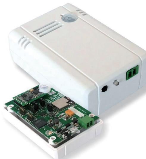
图 4. 分销商 Arrow Electronics 设计了一个名为 Sentimate 的无线传感器单元，该产品采用 TE Connectivity 的 AmbiMate 传感器，以灵活的组合方式将无线电和电池组件结合在一起，为产品开发人员提供了便利。
