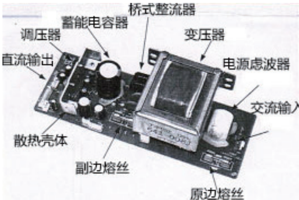
图3 基于线性技术的典型电子式低压直流电源
