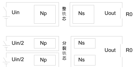
图 1 分裂式铁芯绕线方式
