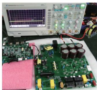
图 15 样机 PCB 实物及实验平台
