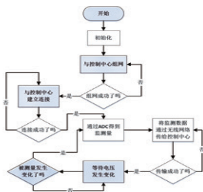
图2 终端节点软件流程图
