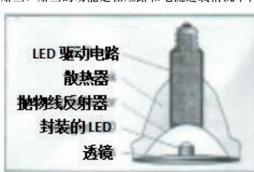
图 1 典型的住宅用 LED 灯结构
