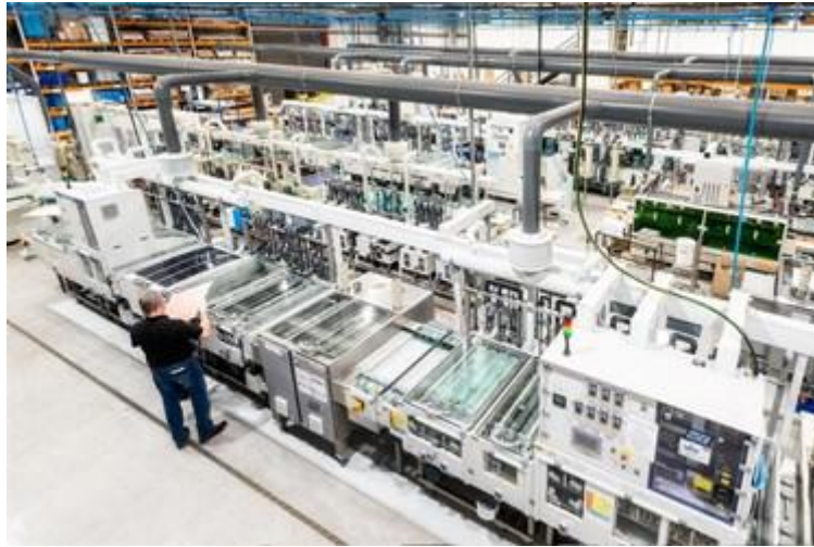
图 1. Trackwise 公司 Tewkesbury 制造工厂的 PCB 化学工艺生产线。
