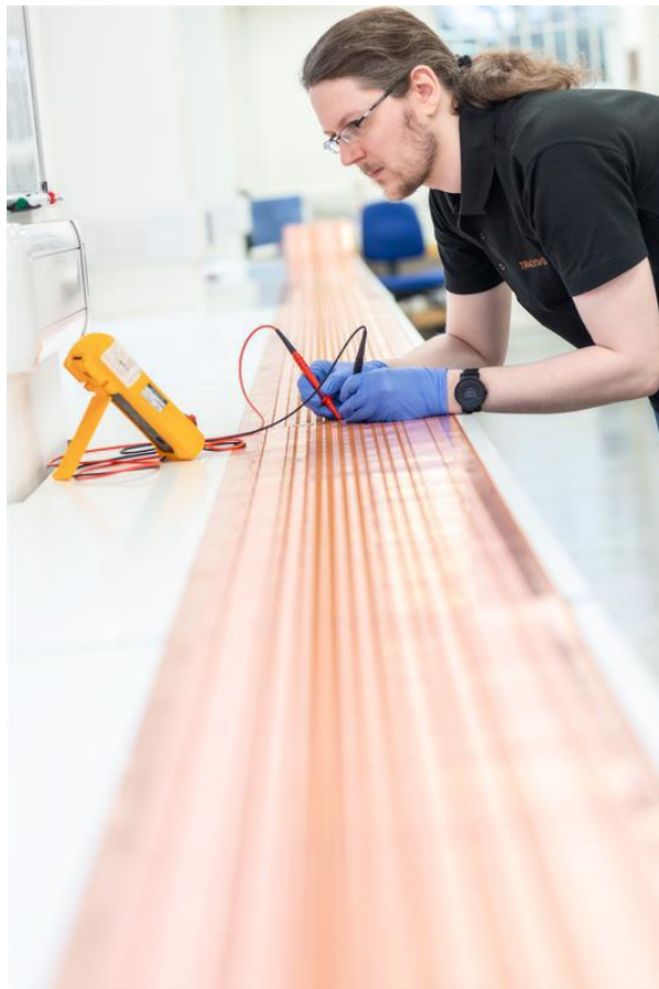
图 2. 电路检查——检查轨道之间的电气隔离。
