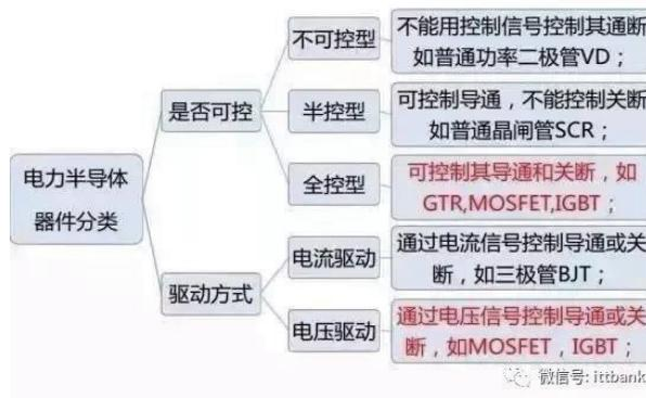
简单讲，是一个非通即断的开关，IGBT 没有放大电压的功能，导通时可以看做导线，断开时当做开路。IGBT 融合了 BJT 和 MOSFET 的两种器件的优点，如驱动功率小和饱和压降低等。
