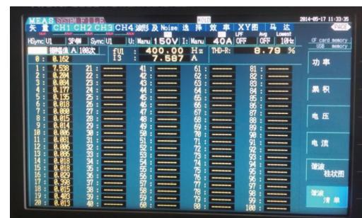
图 15 C 相输入电流谐波分量清单
