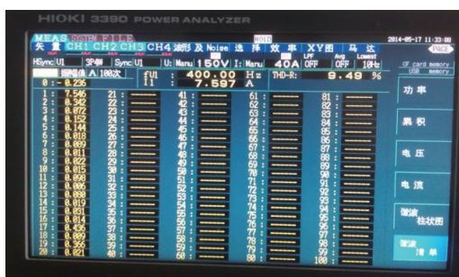
图 11 A 相输入电流谐波分量清单
