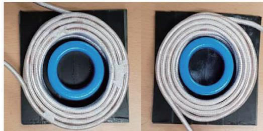
图 2 发射 (左) 和接收 (右) 线圈。线圈制造中使用的
