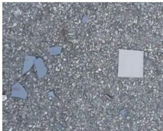
图 5 两个磁体的跌落测试结果
