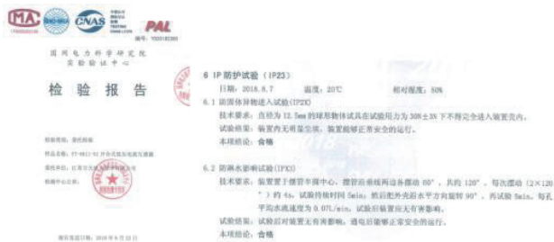
图 3 江苏电网开合式电流互感器 IP 防护等级测试结果
