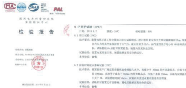
图 5 江苏电网开合式电流互感器 IP 防护等级测试结果
