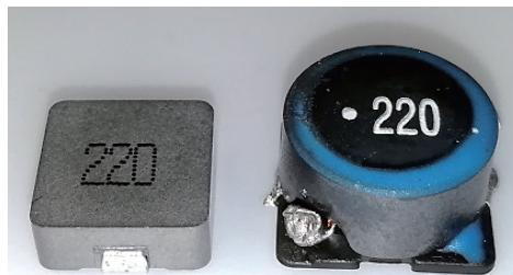
图2 一体成型电感与传统电感实物图对比
