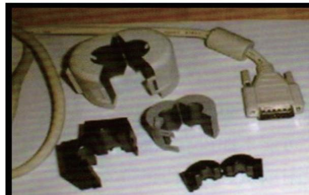
图 3 (c) 为多种圆柱形软铁氧体分裂模式
