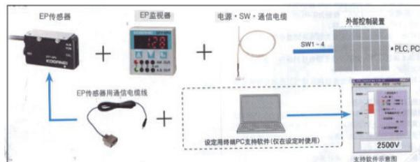
图 7 所示 EP 传感器连接实例——EP 监视器连接框图
