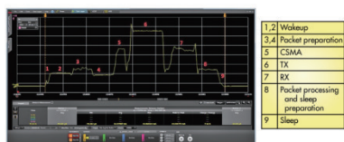
图 1 为在无线数据传输期间，不同操作阶段的电源电流与时间的关系。
