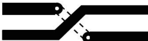
图 5 PCB 板上实现双绞线式的最小回路
