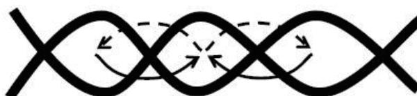
图 4 双绞线回路抵消示意图
