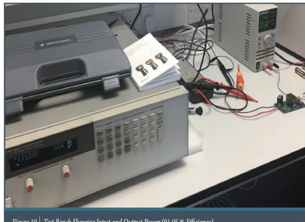
图 10 测试台显示了输入和输出功率情况 (效率为 91.05%)
