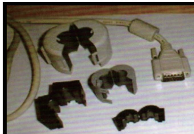
图 6 (c) 为多种圆柱形软铁氧体分裂模式
