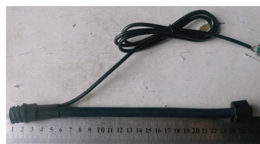
图 4 长度 25cm，参数 100mV/kA。
