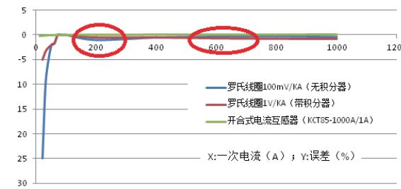
图 8 RCT 的线性度有波动而开合式 CT 线性度较平稳
