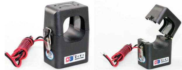
图 3 星火电子生产的 SCT 系列开合式电流互感器，一次侧开合式设计，即是铁心经过切割后安装在外壳内，左为一次侧闭合状态，右为一次侧打开状态。
