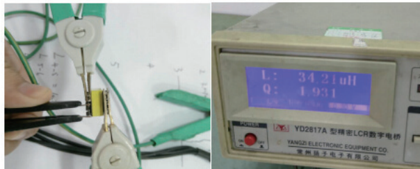
图 15 变压器测试漏感
