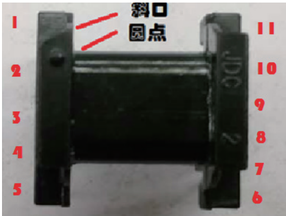
图2 EPC19骨架脚位定义，很多骨架上面都会有个斜口或者圆点，这个可以作为明显的标记
