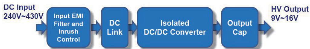
图 7 小功率 DCDC 单向变换器电路方式
