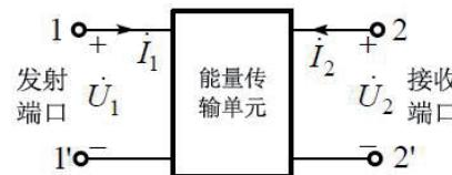
图3 WPT系统的二端口网络模型
