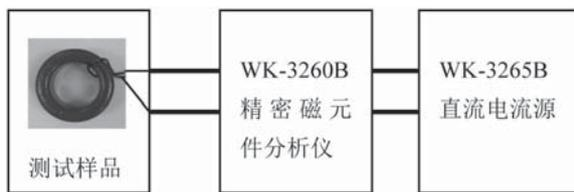
图 4 直流偏磁下动态磁导率测试原理图
