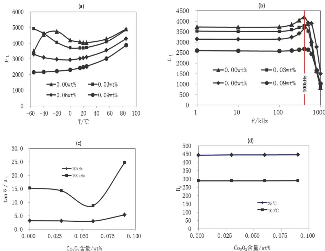
图2  $\text{Co}_2\text{O}_3$ 掺杂量对材料性能的影响
