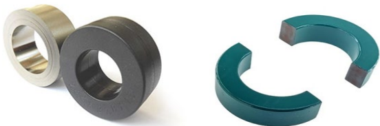
图4 卷绕成环型的超微晶铁心, 由于带材极薄, 所以一般形状比较单一, 一般为环型、CD型, 同时也可以进行切割, 如右图
