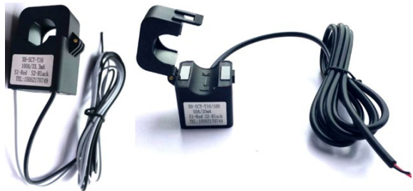
图1 江阴市星火电子科技有限公司生产制造的磁材为铁氧体的开合式电流互感器, 其信号输出为mA级小电流或者mV级小电压
