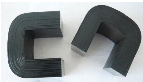
图3 卷绕成CD型再切割的硅钢铁心, 一般用在变压器或者开合式电流互感器
