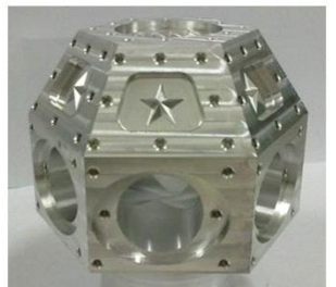
图5.5 加工零件 (五轴3+2定位加工)
