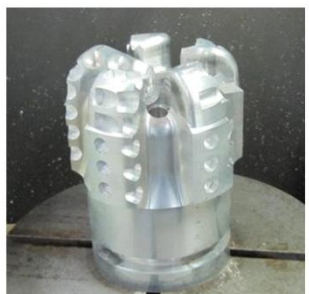
图5.3 加工零件图 (石油勘探钻头)
