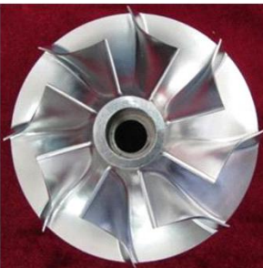
图5.4 加工零件 (叶轮)
