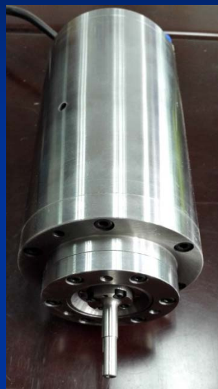
感应电机 3kW, 30krpm 加工中心
